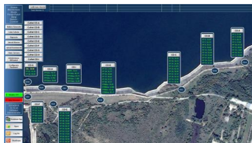
Figura 10 Ecranul principal al soft-ului SCADA.
