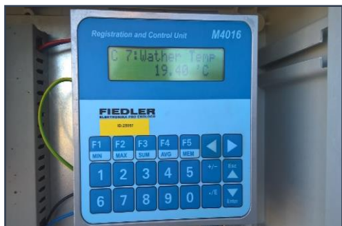
Figura 7 – Aparataj pentru înregistrarea cotei nivelului de apă și temperaturii în lacul de acumulare.
